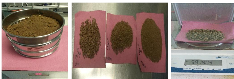
Figura 9: Determinación de textura (pesaje, tamizado y separación de fracciones).
