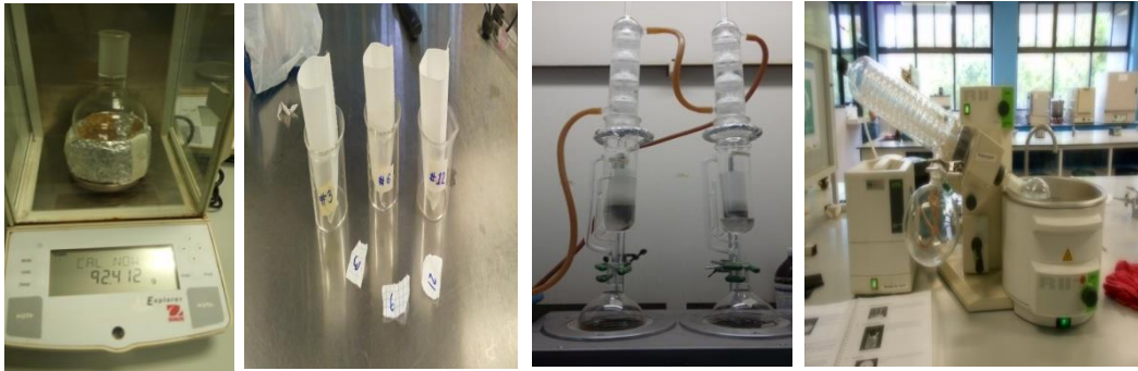
Figura 14: Método de reflujo tipo Soxhlet para la extracción de grasas y aceites.
