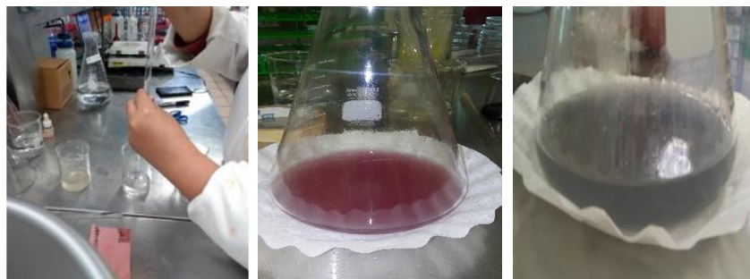
Figura 12: Determinación del Intercambio Catiónico Total (Titulación de la muestra).
