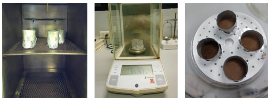
Figura 10: Determinación de humedad (pesado y peso constante).
